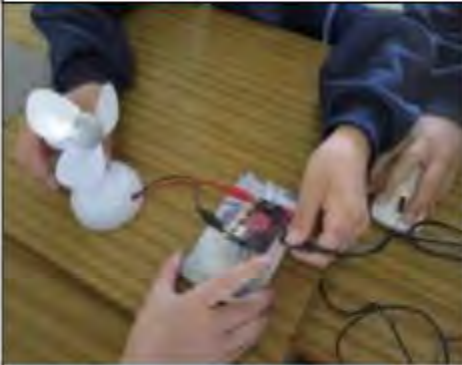
温度センサーを活用し、26度以上になるとスイッチがオンになる扇風機
