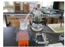
図1 水蒸気蒸留
