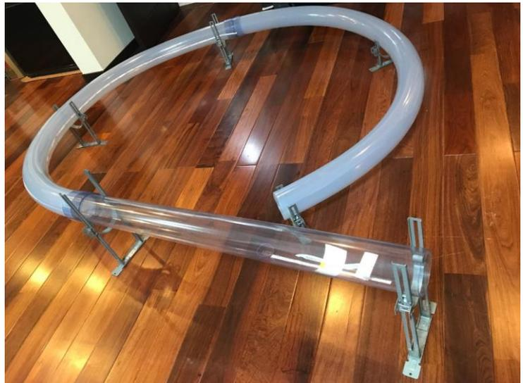
図12 カーブしたチューブを増設し、ほぼ一回転できるようにした実験ルート
