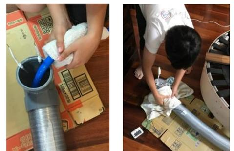
図4 塩化ビニルパイプにアルミダクトと水を入れ、90°Cに加熱して円弧状に曲げた。
